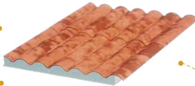
Panel de aislación térmica de techumbre de doble chapa de acero y núcleo aislante de Poliuretano. Se recomienda su instalación en configuraciones de techo cálido para dar cumplimiento al riesgo de condensación intersticial y superficial.
